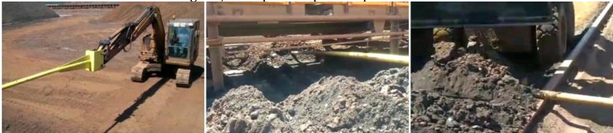
Figura 7 – Dispositivo para limpeza sob correia
