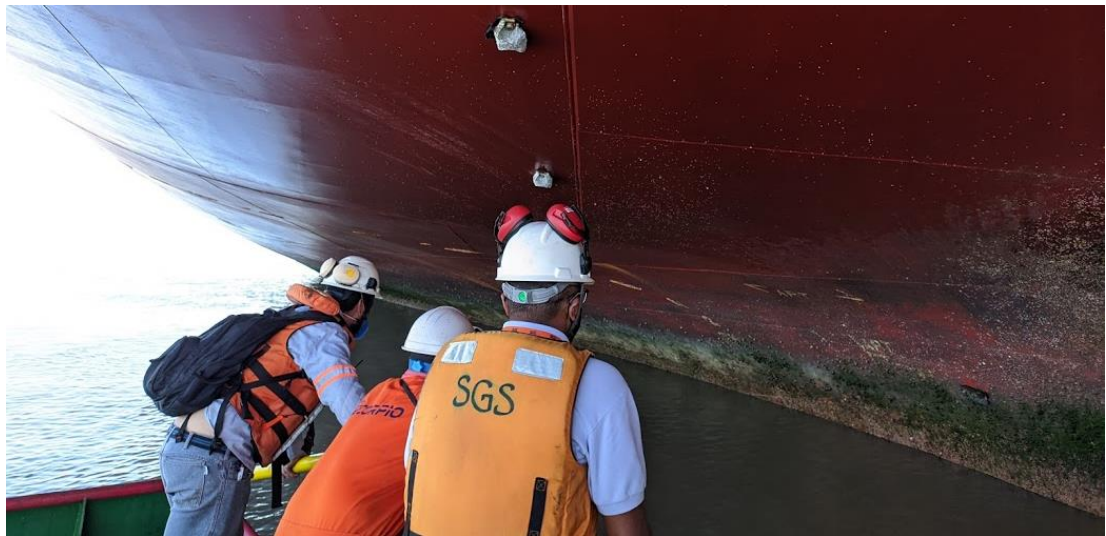
Figura 9 – Leitura de calado no bombordo da popa do navio no Porto do Itaqui
