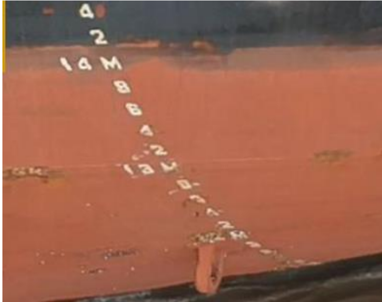
Figura 15 – Curvatura na popa do navio dificultando a visualização das marcas de calado
