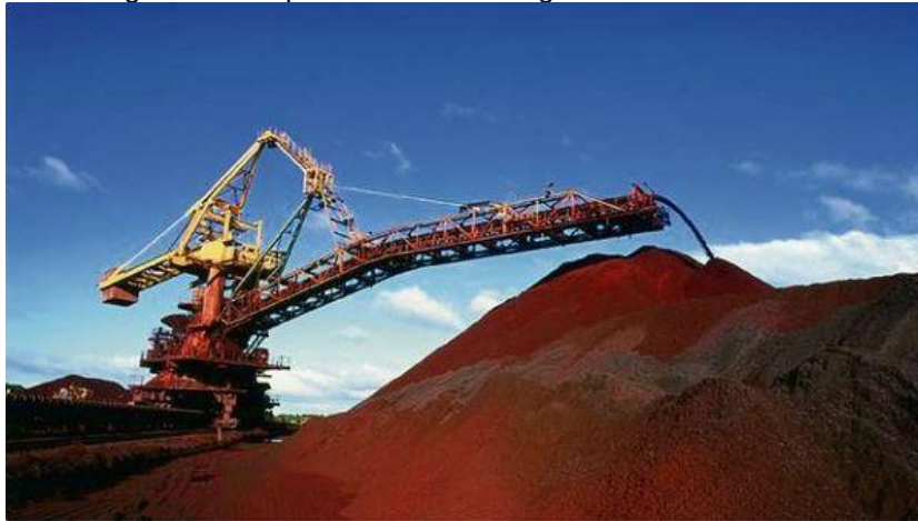
Figura 4 – Empilhadeira descarregando minério de ferro
