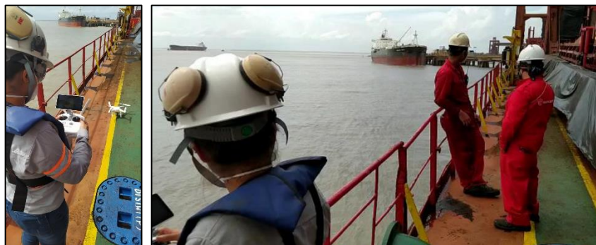
Figura 14 - Inspetora realizando a arqueação por drone
