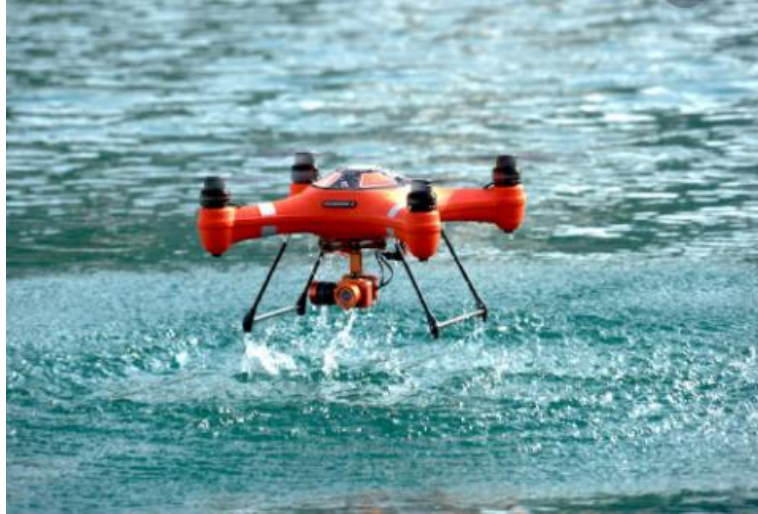
Figura 16 – Drone à prova d'água e com opção de pouso em água
