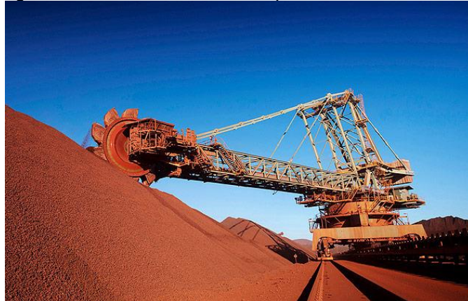
Figura 5 – Stacker reclaimer recuperando minério de ferro
