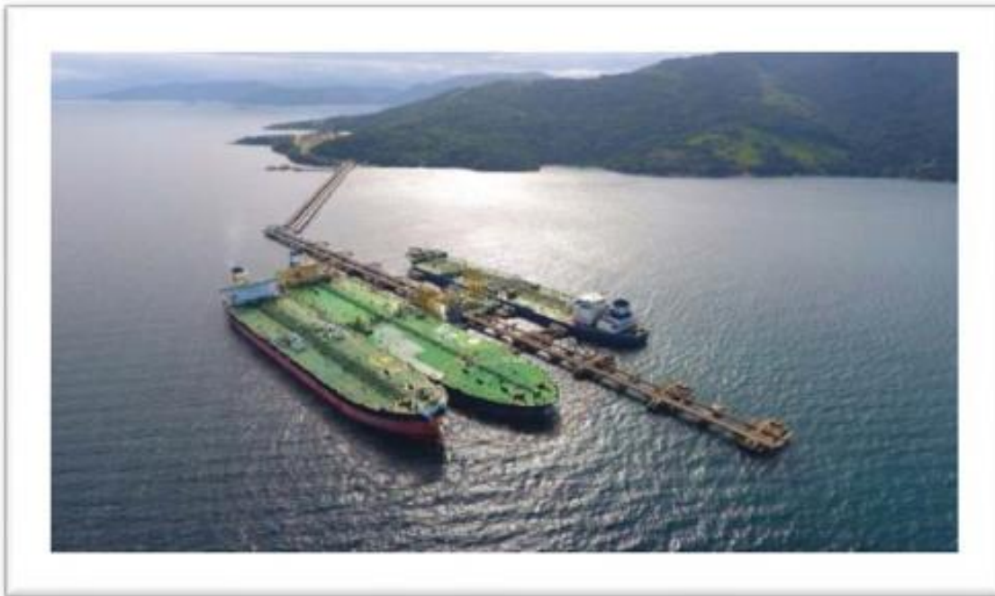
Figura 2 - Operação STS atracado em instalação portuária.
