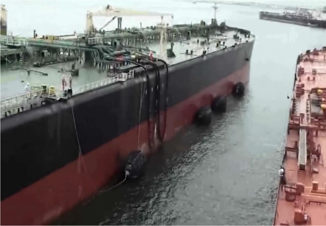
DEFENSAS PRIMÁRIAS E MANGUEIRAS DE TRANSFERÊNCIA DE CARGA
