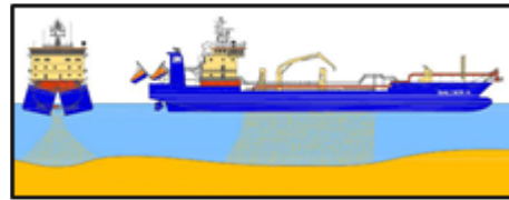
Figura 3: Esquema de despejo de Draga Tipo TSHD Fonte: RADA, Vale, 2021.
