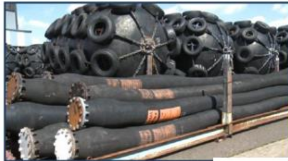
ARRANJO TÍPICO DE DEFENSAS PRIMÁRIAS (FENDERS)
