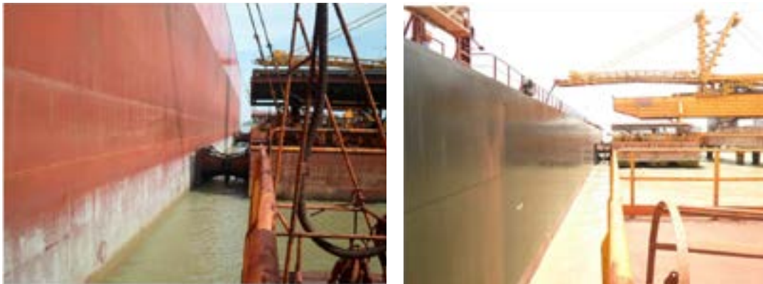
Figura. 7 – Esforço nas defensas no começo e final do carregamento.
