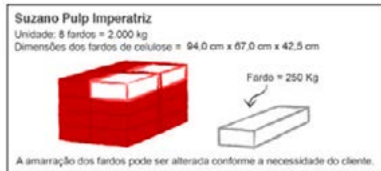
Figura 4 – Especificações da celulose comercializada pela Suzano
