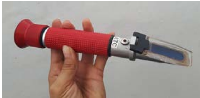
Figura 6 – Refratômetro utilizado na medição da salinidade e densidade.
