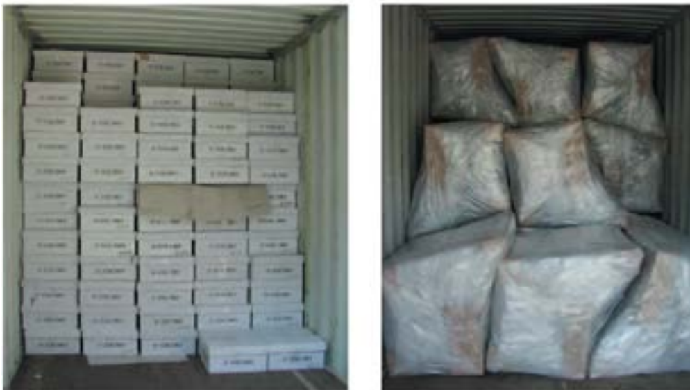
Figura 1- caixas e sofás carregados com encaixe positivo
