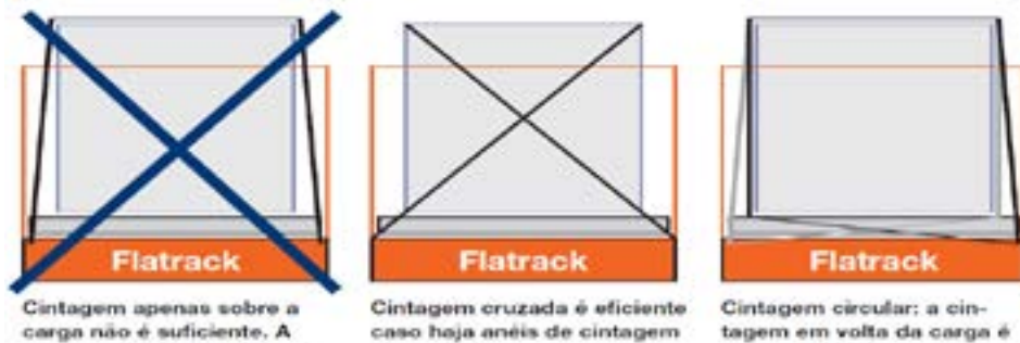
Figura 3- amarração de carga em contêineres flat-racks
