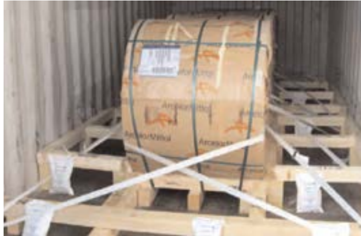
Figura 2- bobinas de aço amarrada com cinta de aço
